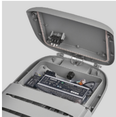
Caja de protección eléctrica IP66. Corte automático de la alimentación cuando se abre la tapa.
